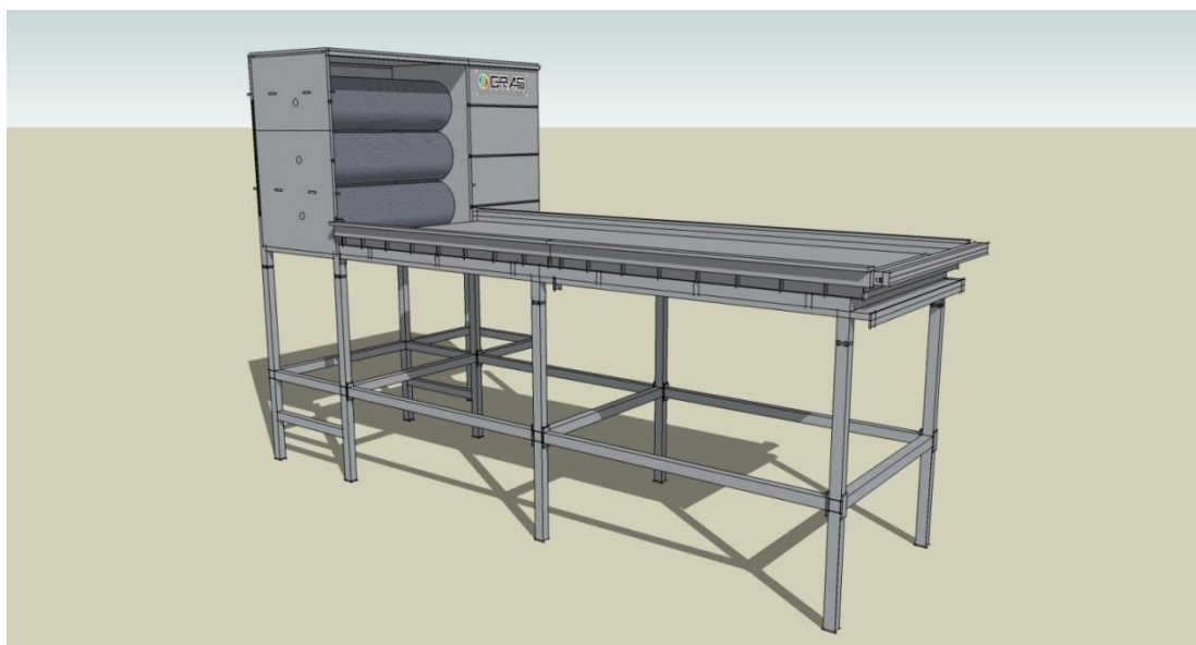
Rys nr 1. Szarpacz słomy 3-bębnowy ze stołem podawczym
